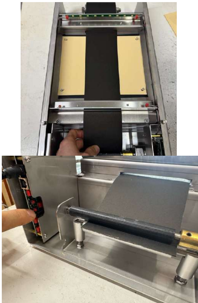
4. ábra: Az alap lőlapmaszk és a fekete papírtekercs behelyezése.
