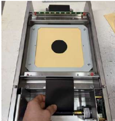
5. ábra: Lőlapmaszk elhelyezése fémkerettel (balra) és felszerelt előlappal (jobbra).
